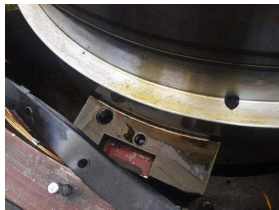
Рисунок 9.5 – Отверстия для установки термобалона ТКП-160 в сегменте генераторного подшипника
