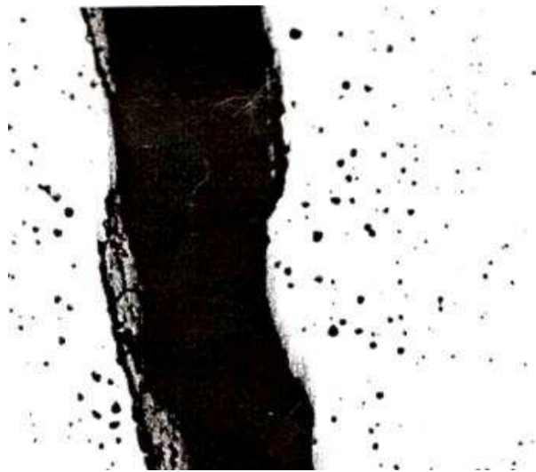
Рисунок 23 – Берега трещины с неметаллическими включениями
