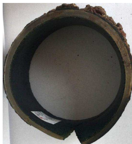
Рисунок 18 – Поврежденная труба ШВП: a – внешняя сторона; б – внутренняя сторона
