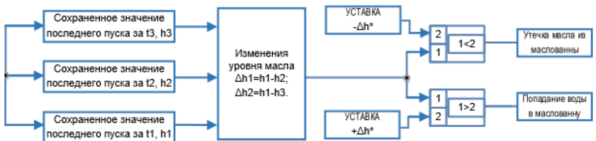
Рисунок 27 – Функциональная часть алгоритма изменения уровня масла в маслованне на работающем
