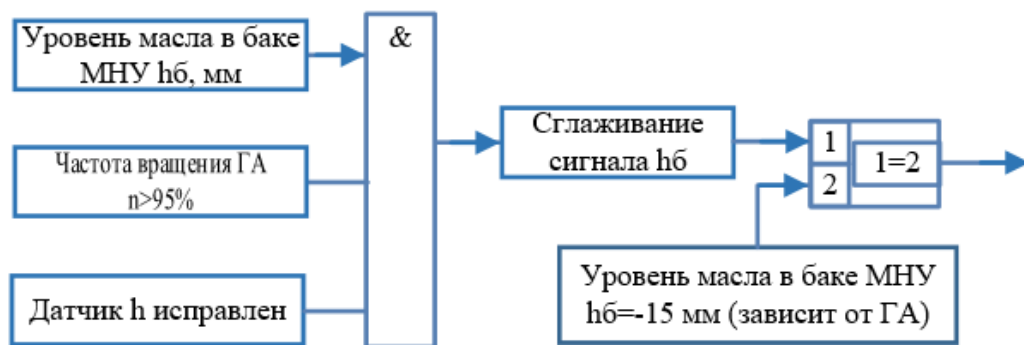
Рисунок 34 – Поиск определённого уровня масла в баке МНУ
