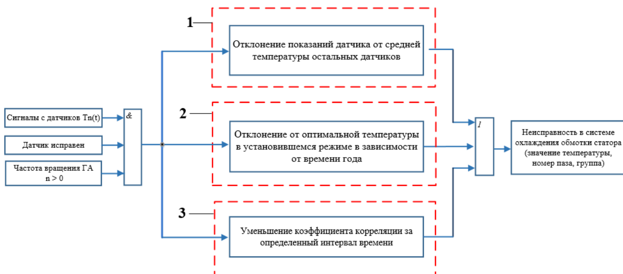
Рис.14 Алгоритм определения средней температуры обмотки статора
