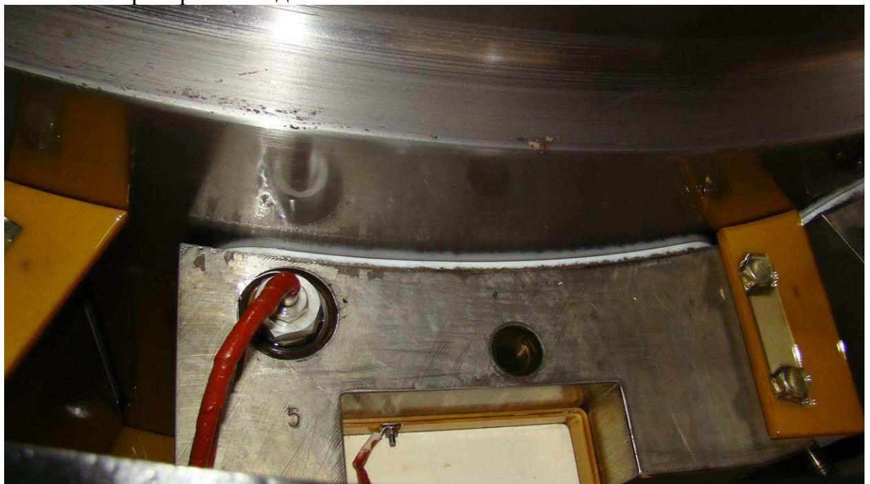
Рисунок 8 - датчик ТК в сегменте подшипника
