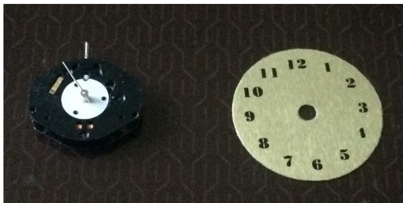
Рисунок 20 – Циферблат и механизм
