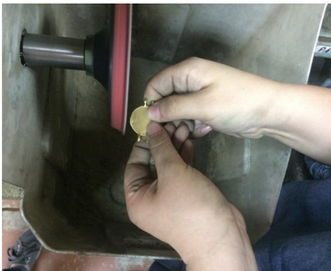
Рисунок 34 – Обработка на шлифовальном станке
