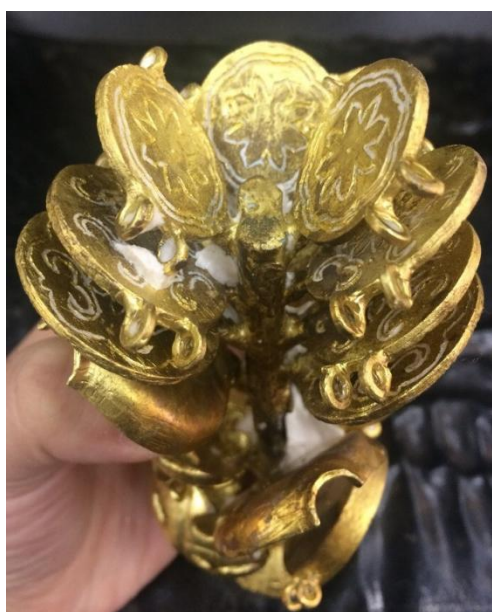
Рисунок 32 – Готовая отливка с литниками
