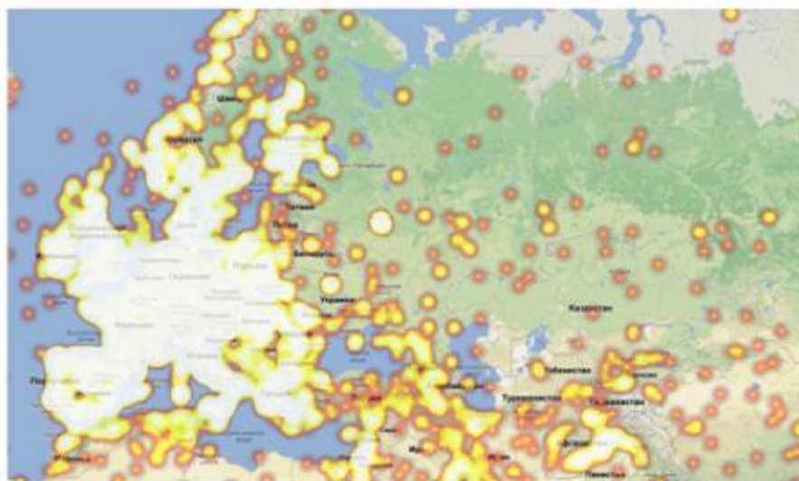
Рисунок 1 – Схема плотности распределения метеостанций на территории Европы и западной части России. Светлые области – наличие большого количества постов наблюдений.
