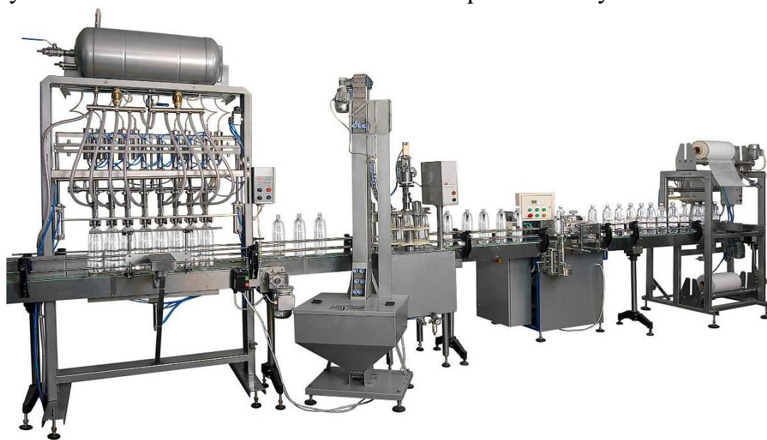
Рис. 1. Схема линии по производству и розливу питьевой воды
