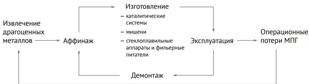
Рисунок 3 – Схема изготовления технических изделий
