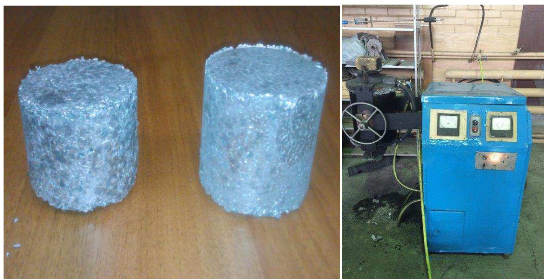
Рисунок 2.1 – Материалы и оборудование: a – брикеты Al–Pb;
