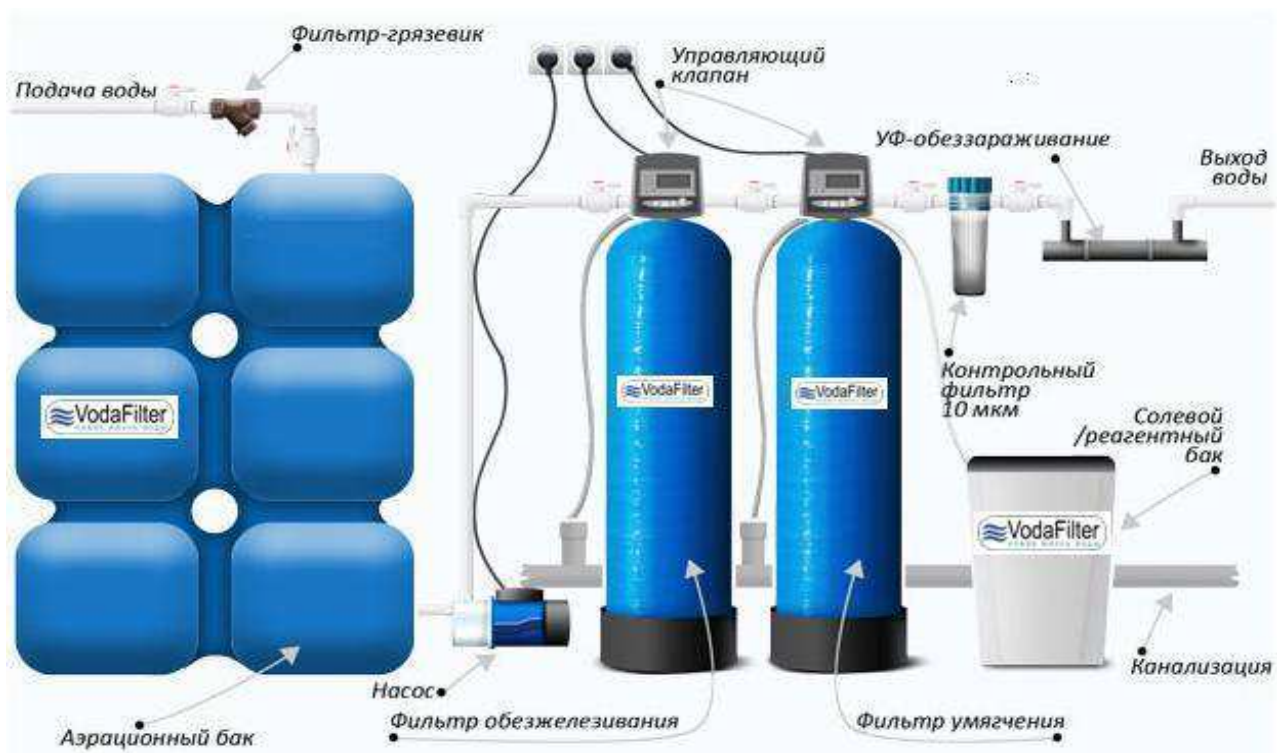
Рисунок 1.7 – Схема обезжелезивания на станции «Амазон-М»
