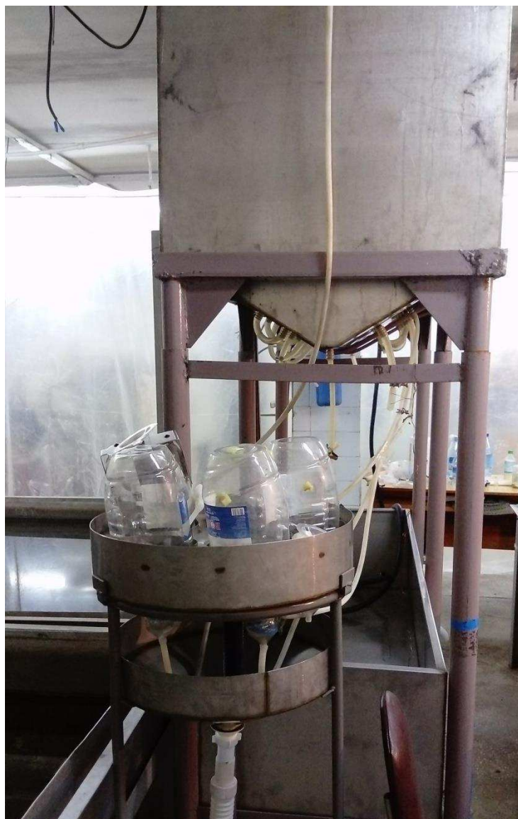
Рисунок 6 – Аппарат для инкубации икры, сделанный по типу аппарата «Вейса» (фото автора)
