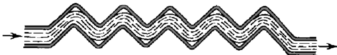
Рисунок 12 - Характер движения потока жидкости в канале, образованном двумя соседними гофрированными пластинами
