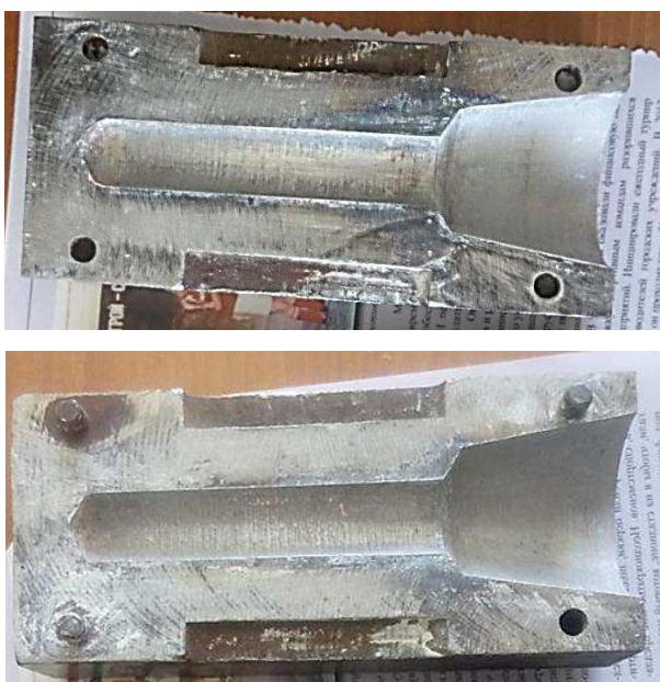
Рисунок 7 – Фотография кокиля для заливки
