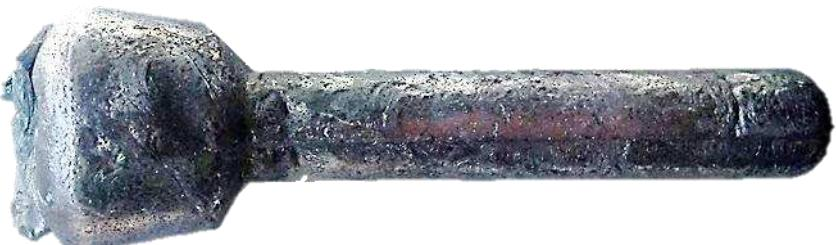
Рисунок 20 – Внешний вид отливки
