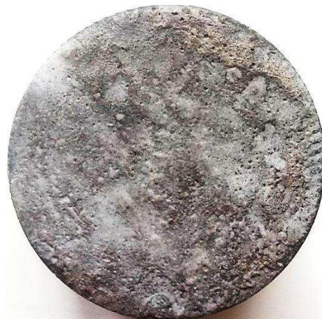
Рисунок 8 – Макроструктура рабочего слоя чугунного образца
