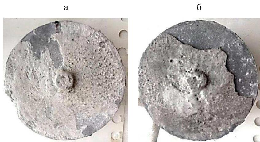
Рисунок 15 – Макроструктура поверхности образцов после опыта: а – краска; б – паста
