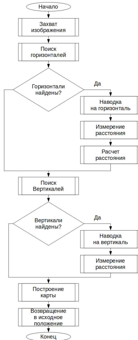
Рисунок 30 — Блок-схема обработки информации с оптического сенсора с использование других сенсоров
