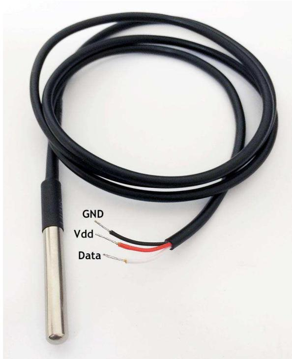
Рисунок 30 – Внешний вид датчика температуры
