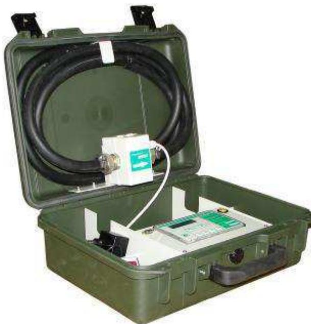
Рисунок 1 - Общий вид установки поверочной переносной УПСЖ 3 ПМ
