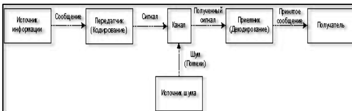
Рисунок 1 — линейная модель коммуникации К. Шеннона
