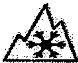
Рисунок 2.3 – Маркировка, наносимая на зимнюю шину
