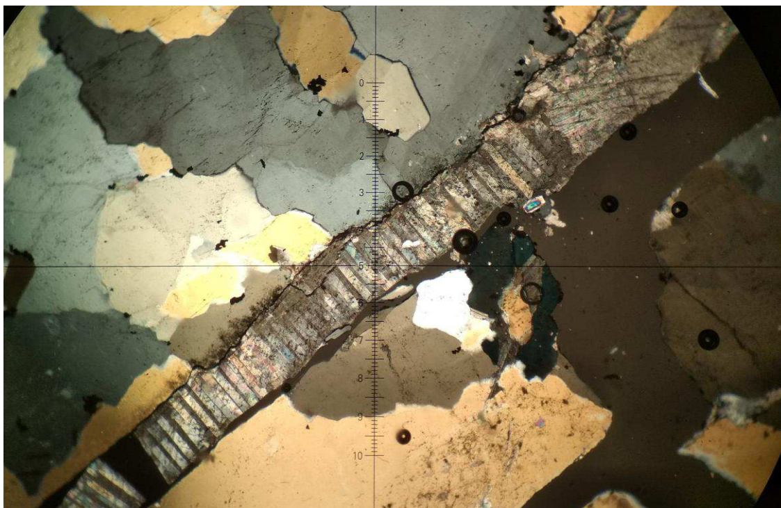
Рисунок 15 — Анкерит (серо-голубовато-розовое, в центре) Полированный шлиф № 2-1. Ув. 35 x . Ник.+.
