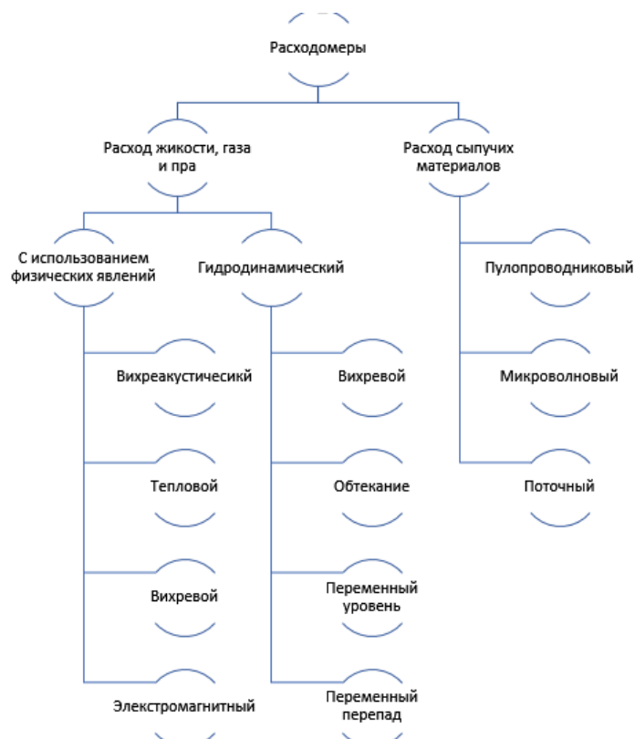
Рисунок 5 - Представление обобщенной структуры в виде И/ИЛИ дерева
