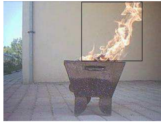
Рисунок 20 – Шаги алгоритма обнаружения пламени. Videопоследовательность Bilkent\barbeq.avi. а – исходный кадр; б – маска пламени; в – анализ области-кандидата; г – результат работы алгоритма.
