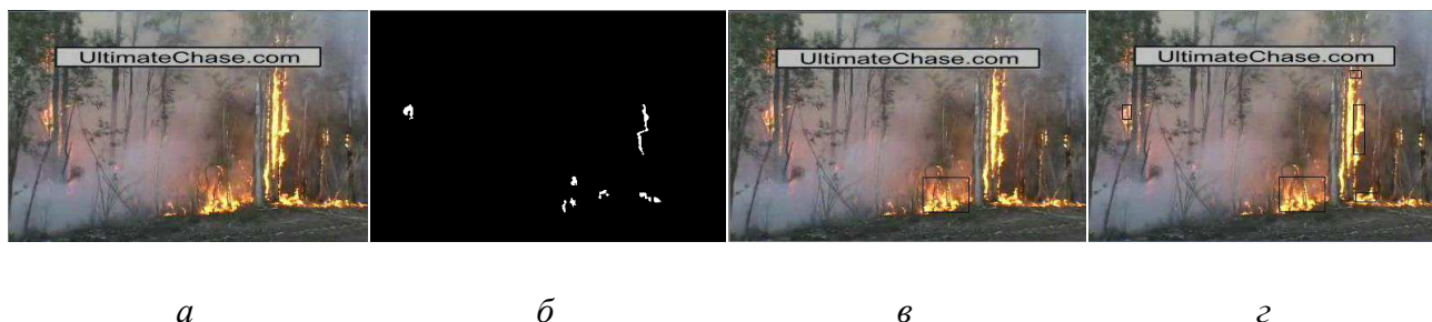
Рисунок 19 - Этапы работа алгоритма обнаружения пламени для видеопоследовательности http://signal.ee.bilkent.edu.tr/VisiFire/Demo/FireClips/Bilkent/ForestFire1 (кадр 316): а – обработка оригинального видео; б – маска цвета пламени; в – поиск движения цвета пламени; г – выделенное пламя.
