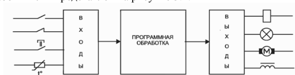
Рисунок 3.1 – Принцип работы ПЛК
