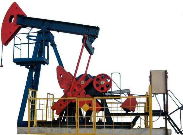
Рисунок 2 – Штанговая скважинная насосная установка
