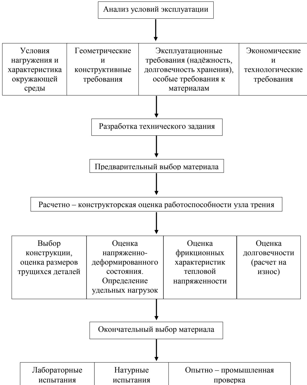
Рисунок 4 – Последовательность действий при выборе конструкционного материала
