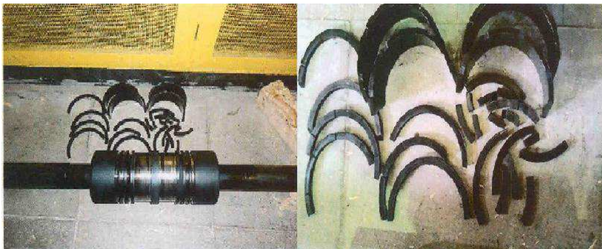
Рисунок 17 – Разрушенные кольца поршня цилиндра
