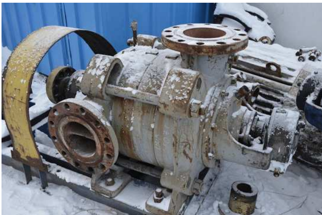
Рисунок 5- Насос типа ЦНС вследствие неправильной эксплуатации
