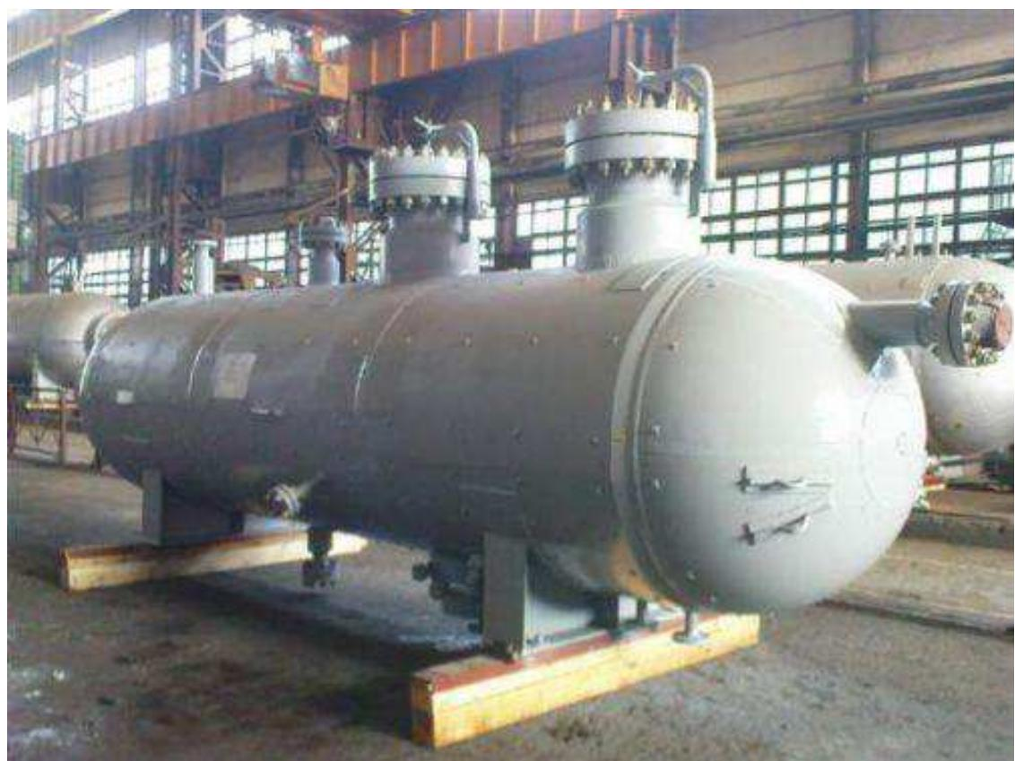
Рисунок 5 – Горизонтальный сепаратор типа НГС
