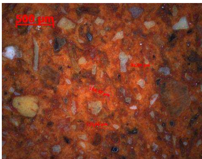
Рисунок 3.8 – Микроструктура керамических образцов
