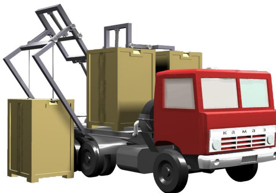
Рисунок 17-Транспортное средство для перевозки малотоннажных контейнеров.
