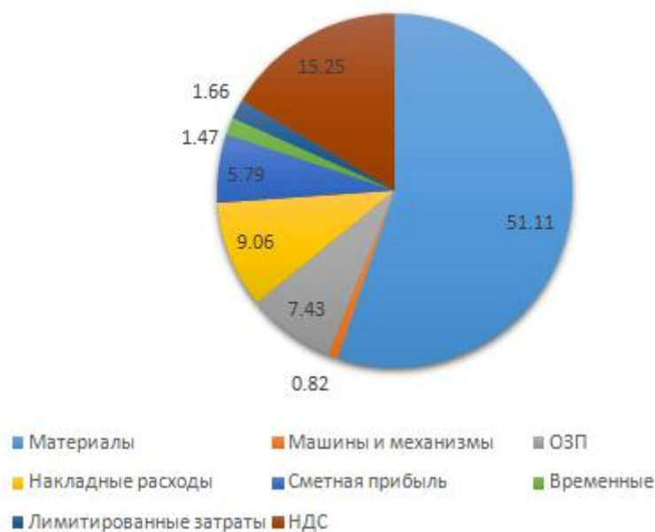
Рисунок 6.3.2 – Структура сметной стоимости локального сметного расчета на возведение опускного колодца по экономическим элементам
