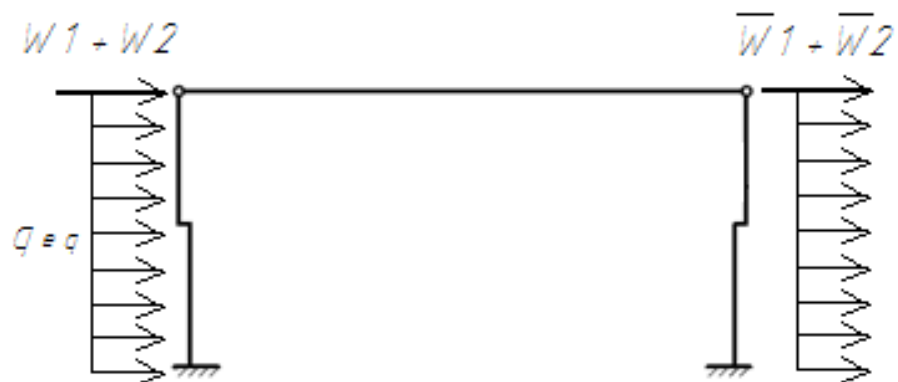
Рисунок 3.2.2.5 – Загружение поперечной рамы ветровой нагрузкой
