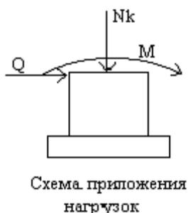
Рисунок 5.8- Схема приложения нагрузок
