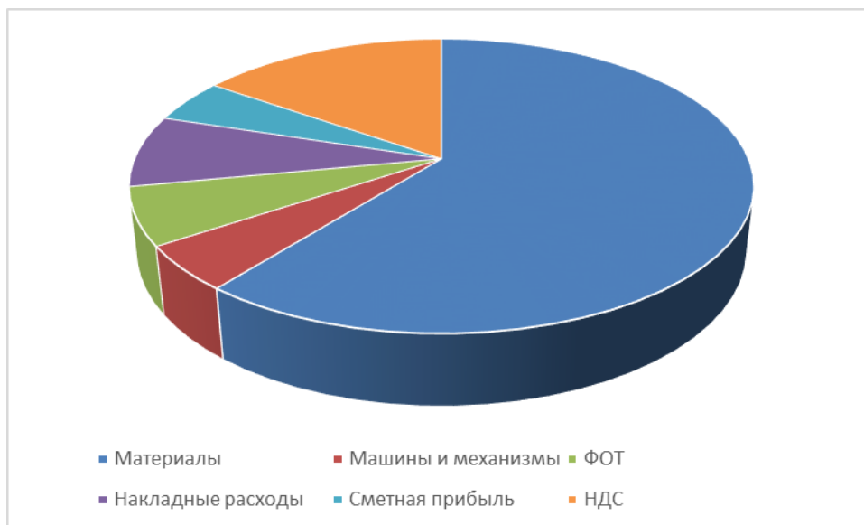
Рисунок 6.2 – Величина и удельный вес затрат в локальном сметном расчете на устройство монолитных стен и перекрытий по составным элементам.
