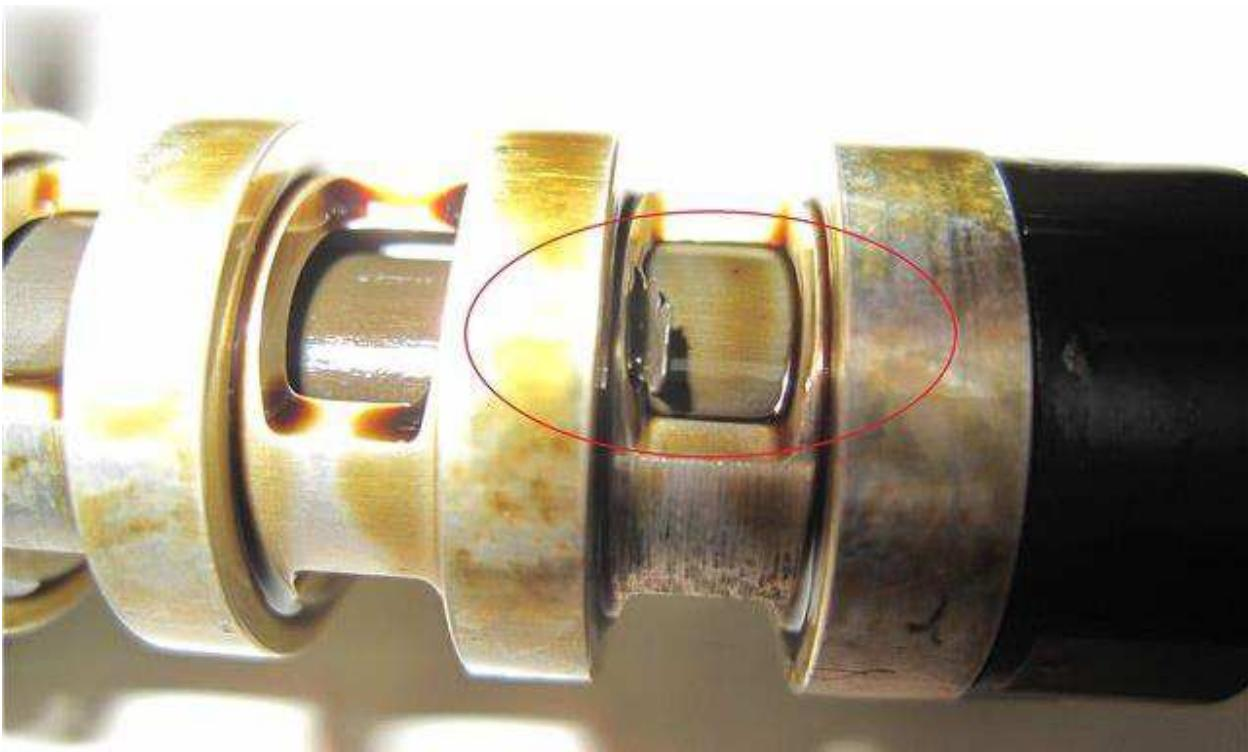
Рисунок 9 – Заклинивание гидравлического клапана куском стружки от шестерни
