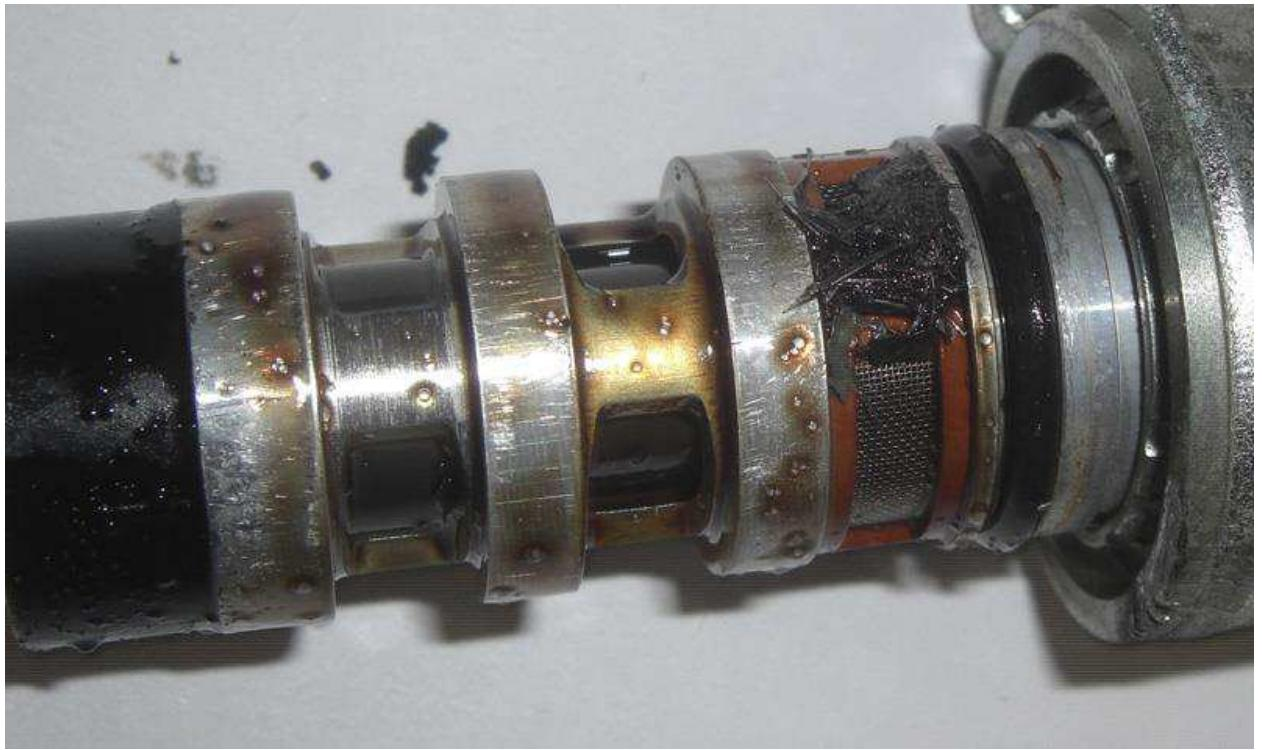
Рисунок 8 – Засорение сетчатого фильтра клапана
