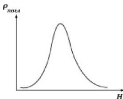
Рисунок 3 – Вид сигнала, полученного ЭПР-спектрометром,
