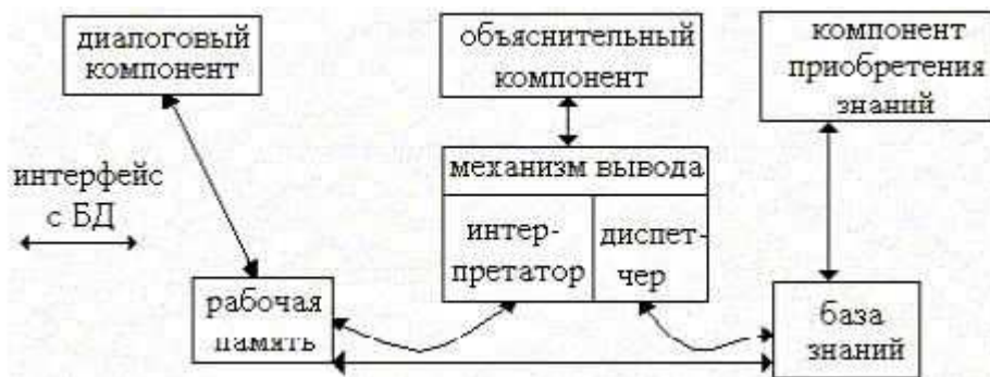
Рисунок 2 – Структура статической экспертной системы
