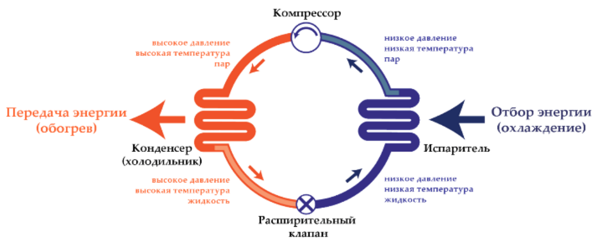
Рисунок 8.2 – Схема работы теплового насоса
