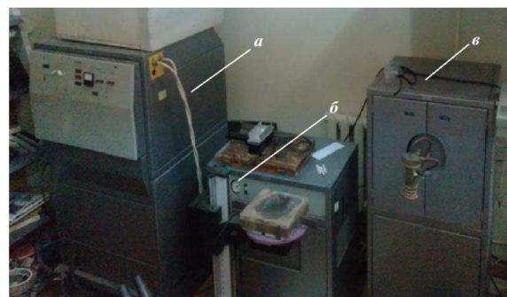
Рисунок 40 – Индукционная установка УВГ-2-25
