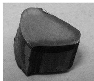
Рисунок 30 – Макроструктура поперечного темпleta зуба зубчатого колеса после разрушения
