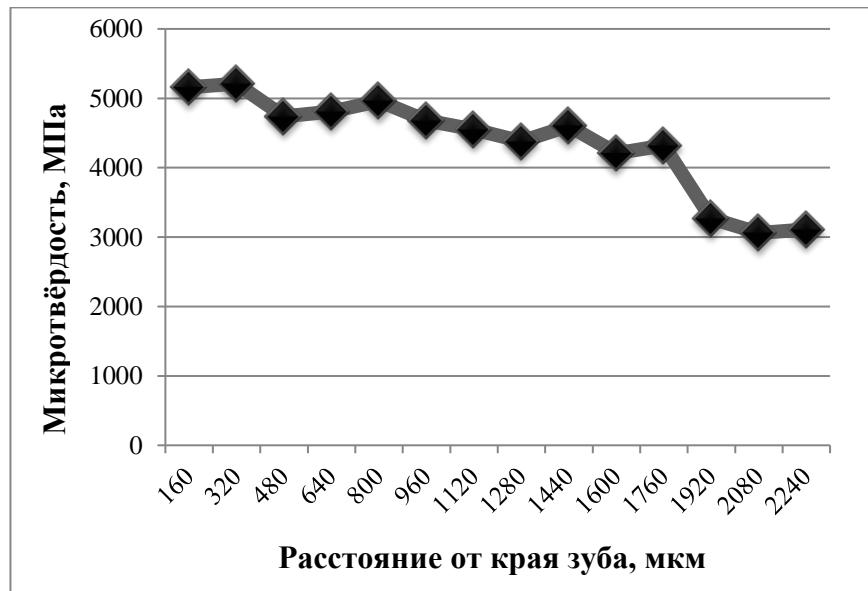
Рисунок 48– Зависимость микротвёрдости от расстояния от края зуба, с выдержкой в 6 секунд
