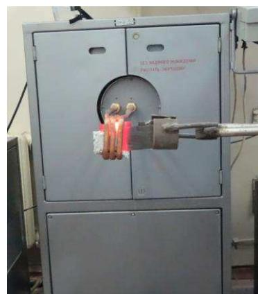
Рисунок 44 – Закалка модели венца колеса
