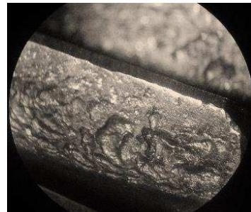
Рисунок 23 – Питтинги на поверхностях зубьев зубчатого колеса
