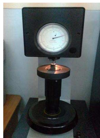
Рисунок 18 – Измерение твёрдости образца на приборе ТК-2М.
