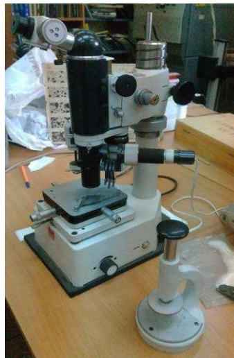
Рисунок 19 – Микротвердомер ПМТ – 3М и ручной пресс.
