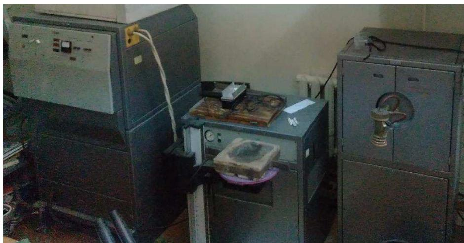
Рисунок 17 – Индукционная установка УВГ-2-25
