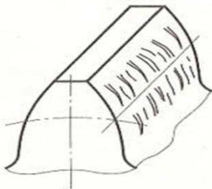
Рисунок 14 Схема задира зуба
