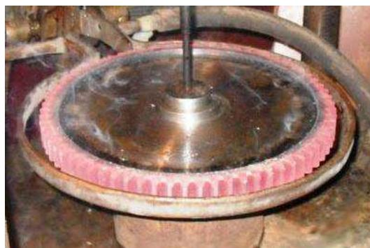
Рисунок 38 – Сквозной нагрев венца зубчатого колеса
