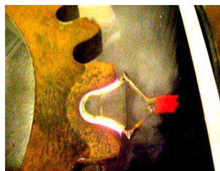
Рисунок 39 – Закалка зубчатого колеса «по впадине»
