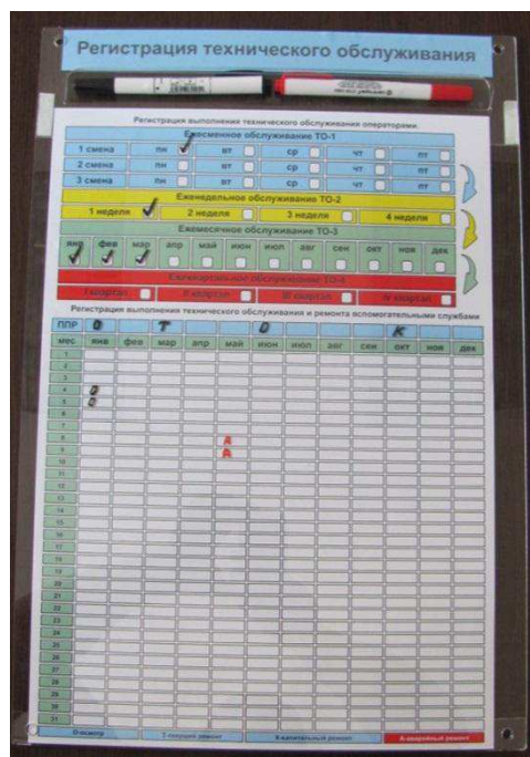
Рисунок 7- План-график ремонта оборудования
