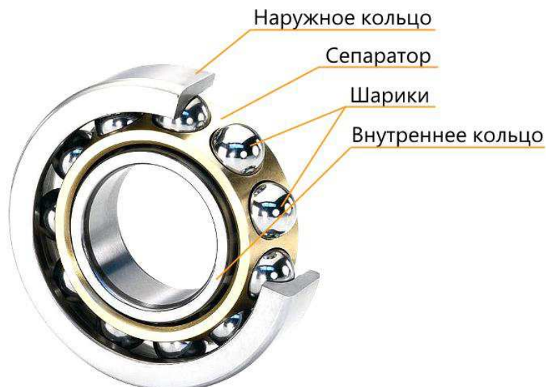
Рисунок 4- Устройство подшипника качения
