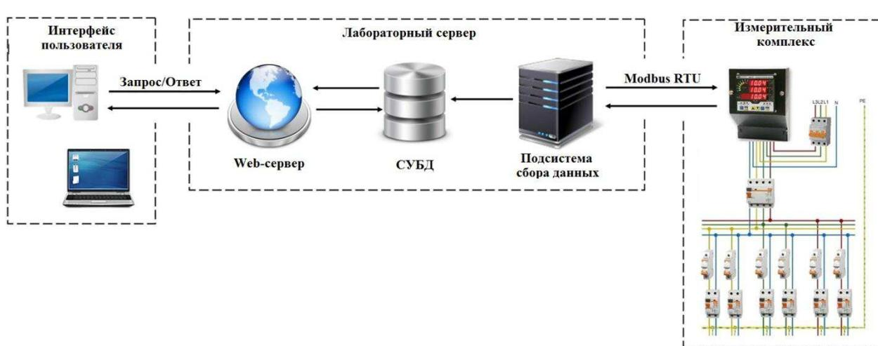
Рисунок 2.1. Архитектура информационно-измерительной системы анализа качества электроэнергии
