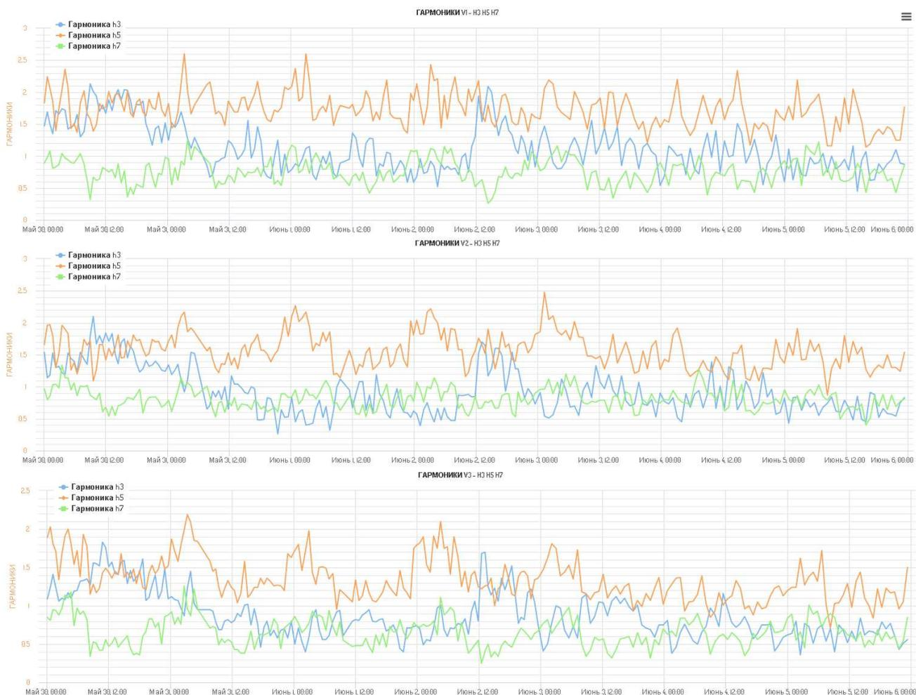
Рисунок 3.4. Гармонические составляющие фазных напряжений: 3, 5 и 7-я гармоники
