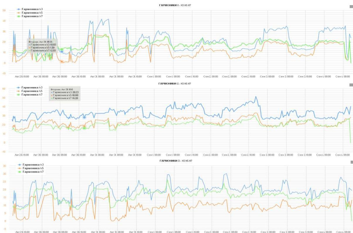
Рисунок 3.12. Гармонические составляющие фазных токов: 3, 5 и 7-я гармоники
