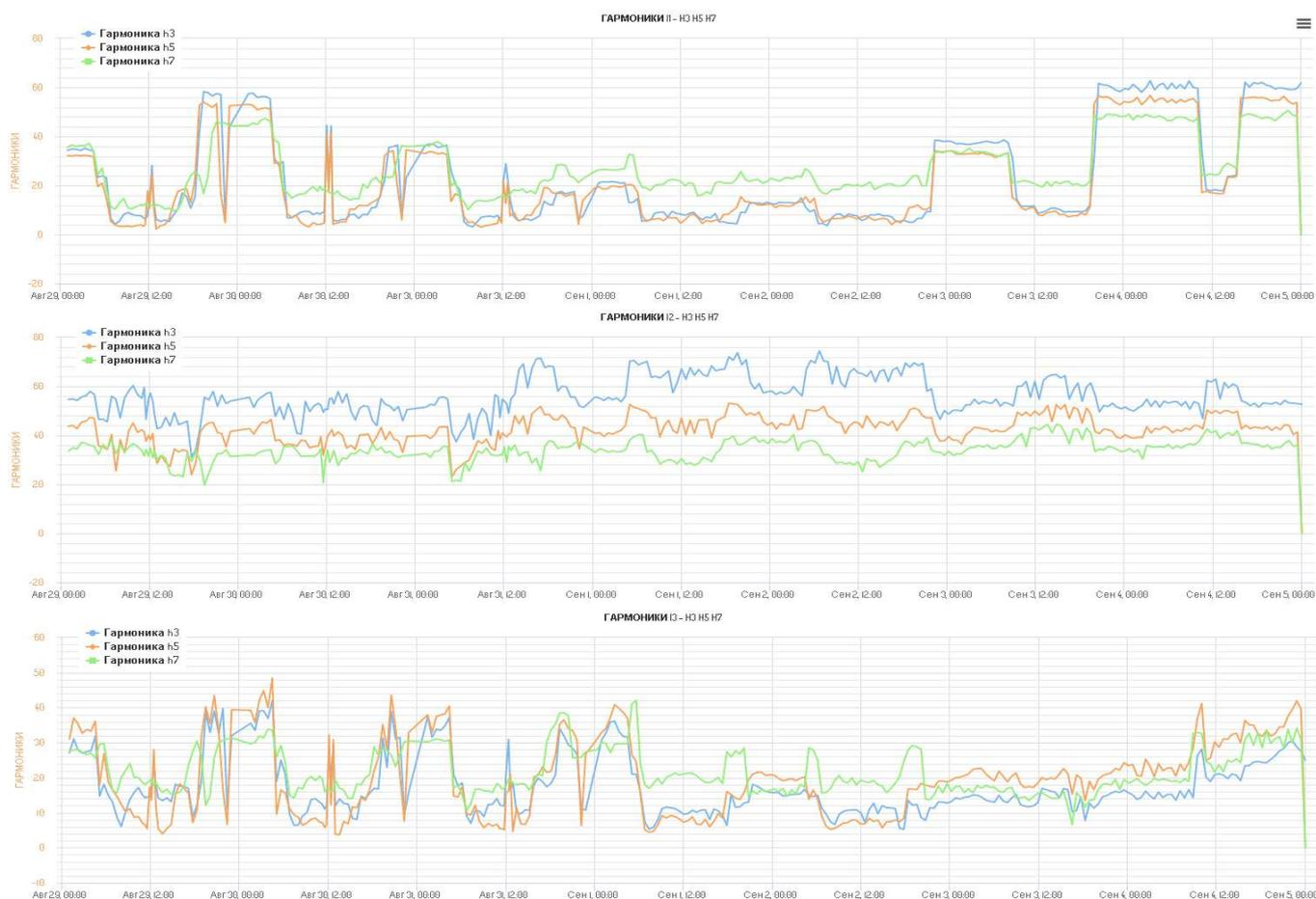
Рисунок 3.20. Гармонические составляющие фазных токов: 3, 5 и 7-я гармоники
