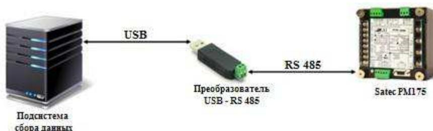
Рисунок 2.3. Схема физических соединений устройств
