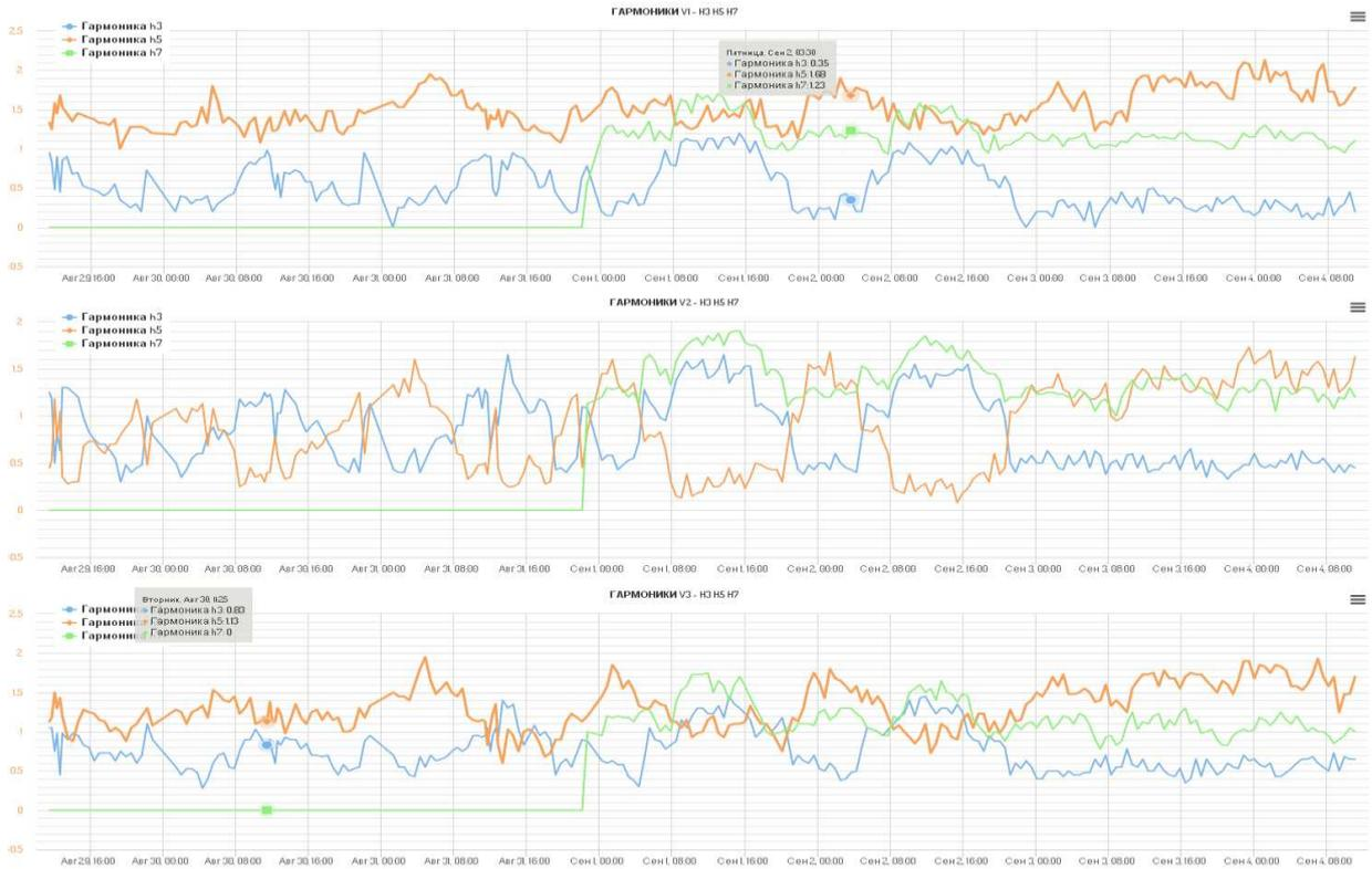
Рисунок 3.21. Гармонические составляющие фазных напряжений: 3, 5 и 7-я гармоники
