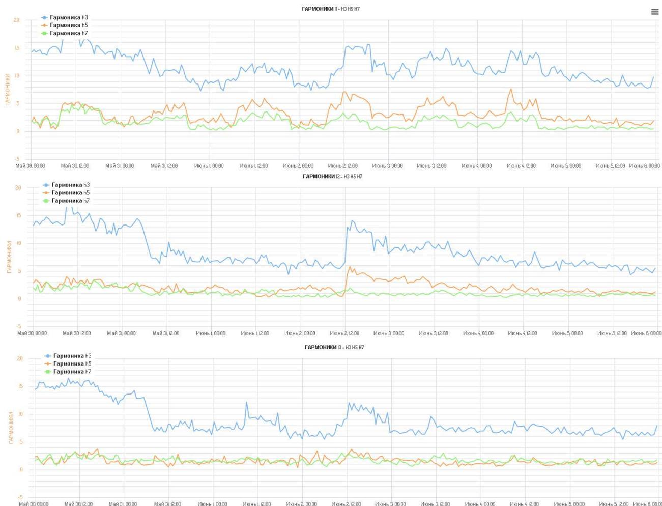
Рисунок 3.3. Гармонические составляющие фазных токов: 3, 5 и 7-я гармоники
