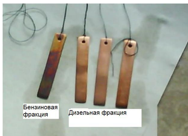
Рисунок 2 – Коррозионной воздействию нефтяных дистиллятов нефти Юрубчено-Тохомского месторождения на медную пластинку
