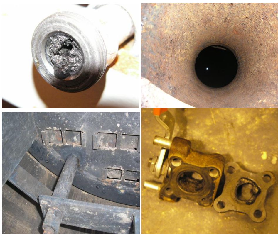
Рисунок 1 – Примеры воздействия нефти на технологическое оборудование при атмосферной перегонке
