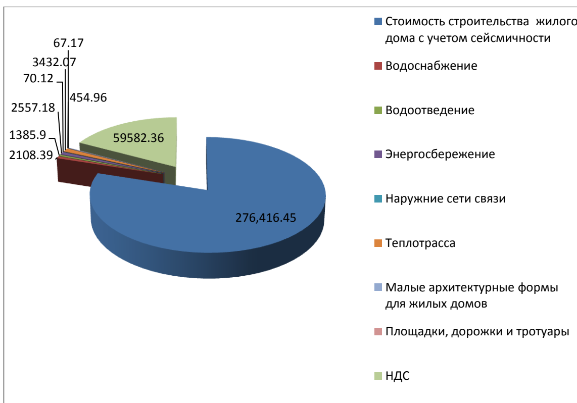
Рисунок 6.4 - Структура стоимости возведения монолитно-кирпичного 24-этажного жилого дома в районе Абаканской протоки на Ярыгинской набережной в г. Красноярске, тыс. руб.
