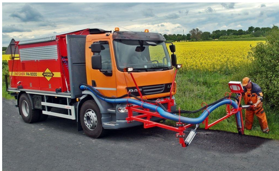
Рисунок 9 – Гудронатор, для обработки струйно-инъекционным способом
