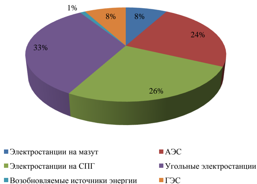
Рисунок 1.5 - Структура генерации электроэнергии в Южной Корее по видам топлива, %
