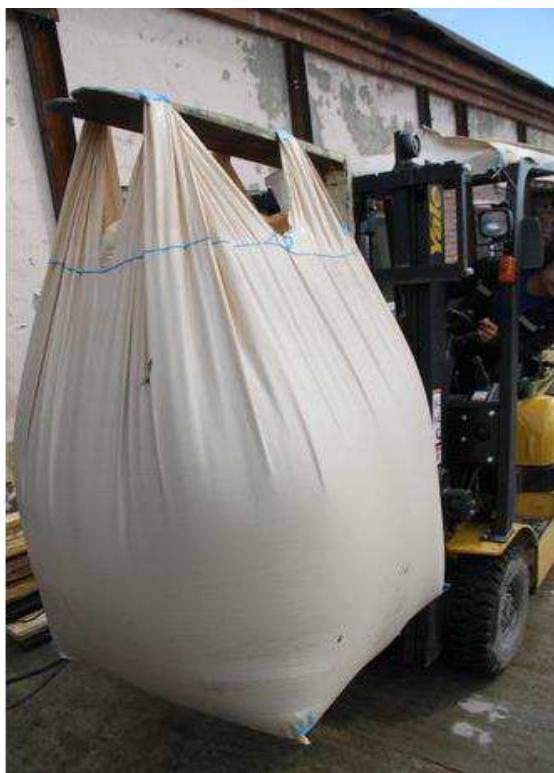
Рисунок 1.1 – Погрузка биг-бегов с глиноземом
