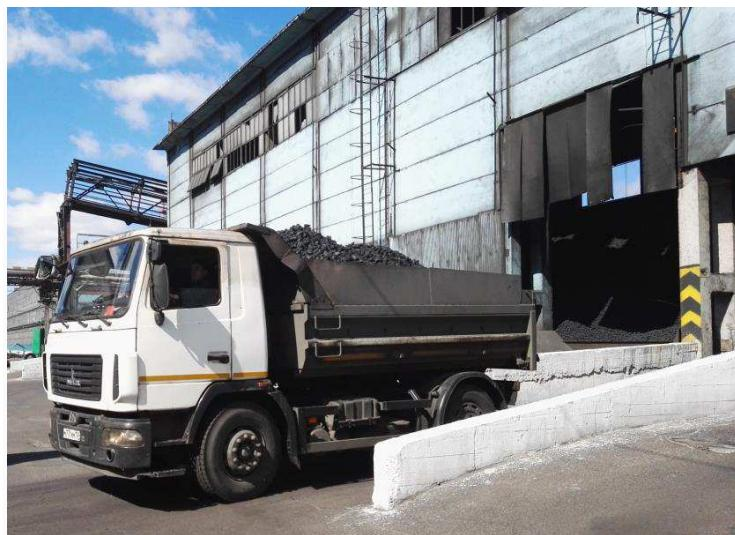
Рисунок 2.9 – Самосвал МАЗ 5551, груженый анодной массой
