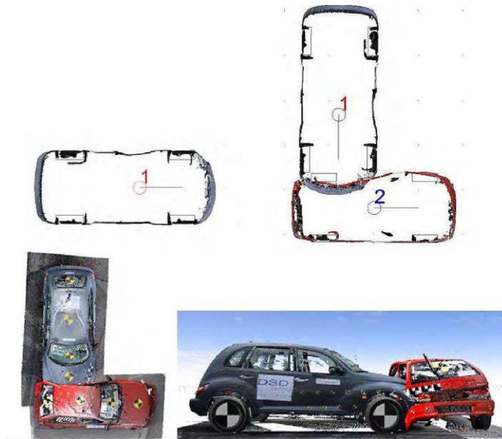
Рисунок 2.10 – Применение сканированных поверхностей ТС
