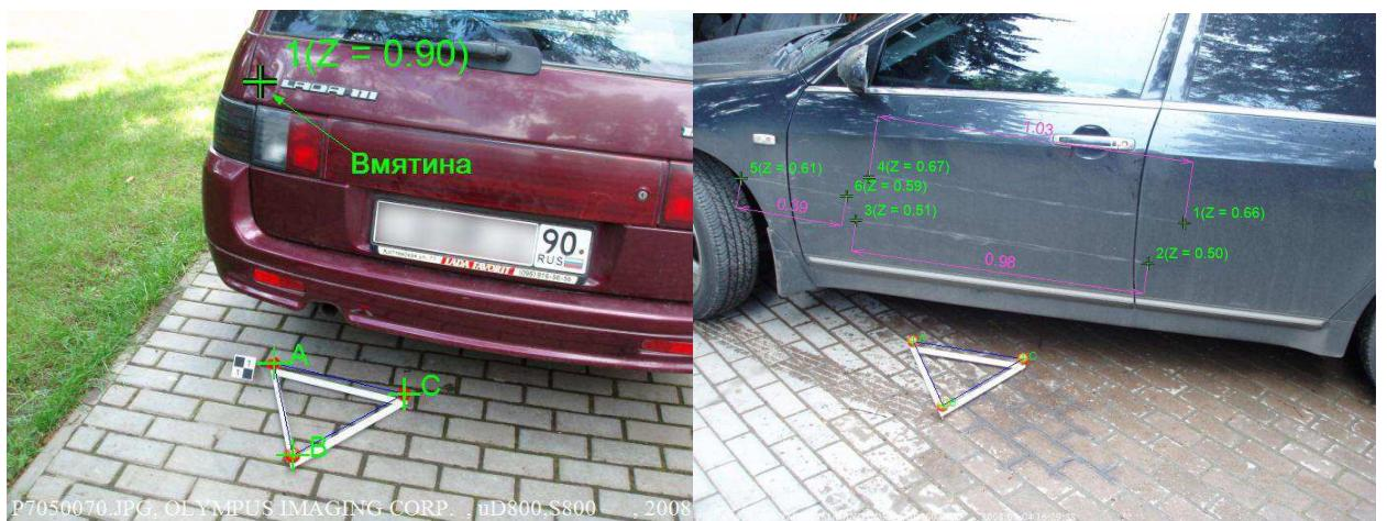
Рисунок 2.39 – Использование программы для определения повреждений автомобиля
