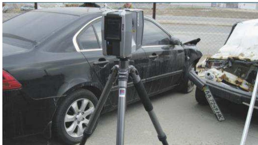
Рисунок 2.40 – Программно-аппаратный комплекс фиксации и реконструкции ДТП Faro Focus 3D
