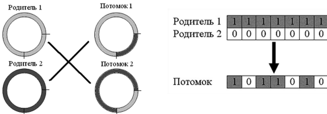
Рисунок 9 – Двухточечное скрещивание (слева) и равномерное (справа)
