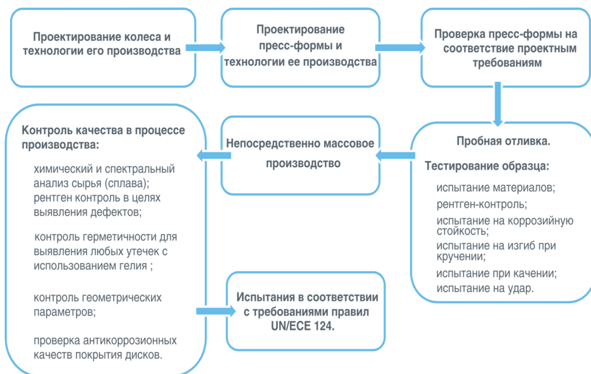
Рисунок 4 – Этапы проектирования и производства продукции
