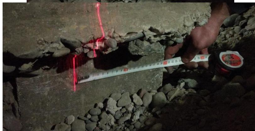
Рисунок 1.15, 1.16 – Фиксирование значений смещения сваи относительно оси Г
