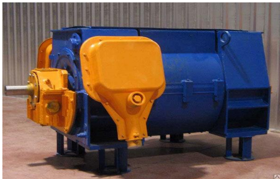
Рисунок А.2 – Электродвигатель 4АРМП 2000/6000 для НМ 2500-230
