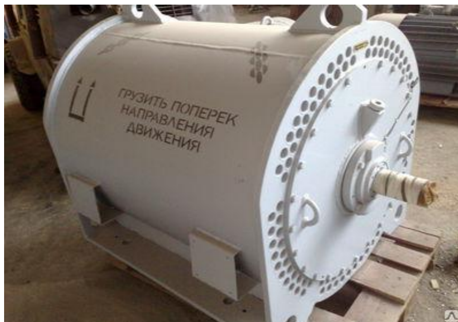
Рисунок А.3 – Электродвигатель ВАОВ – 630-2У4 для НПВ 2500-230
