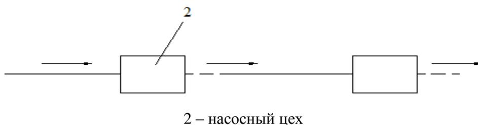
Рисунок 5 – Система перекачки «из насоса в насос»
