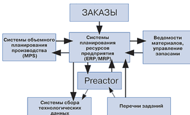
Рисунок 2.1 – Пример использования APS-системы Preactor
